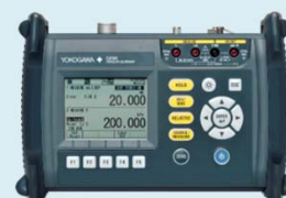
伝送器校正用途 CA700キャリブレータ
